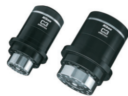
インテリジェントアクチュエータユニット「C3 eMotion」 モータ、減速機、ドライバ、ブレーキ、エンコーダを一体化させた協働ロボット用関節ユニット。
