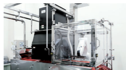
食品業界向け異物検査装置 分光技術とAIで、有機物の検出を可能に。(アヲハタ株式会社と共同開発した、ジャム・フルーツプレッドの製造工程における異物・夾雑物の自動検査を可能にした「ジャム・フルーツプレッド用異物検査装置」)
