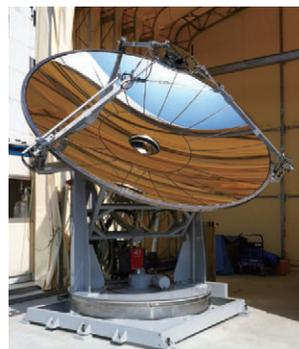
実証実験のための太陽炉
