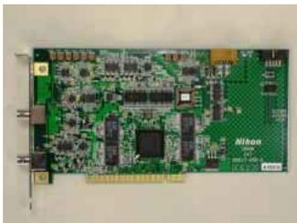
コンフォーカル顕微鏡用画像処理基板
