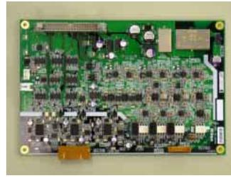
液浸露光装置用モーター制御基板
