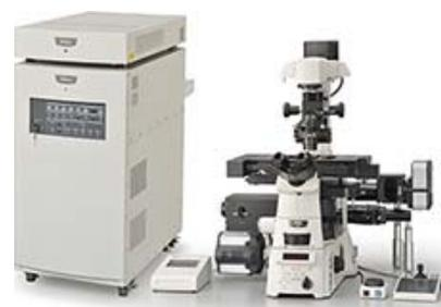
LUコントローラーボックスB（左上）、レーザーユニット LU-NV（左下）とレーザー顕微鏡（右）の組み合わせ
