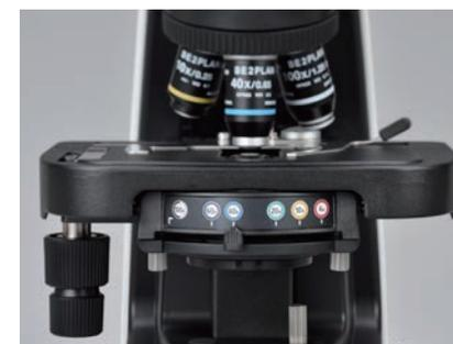
対物レンズに適した開口絞りができるように、コンデンサー開口絞りの位置を、その倍率に応じて、国際規格である「倍率カラーリング」と合わせた色で表示
