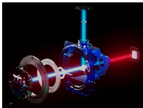
Fig. 3 Tele & Wide 同一光軸カメラの構成
