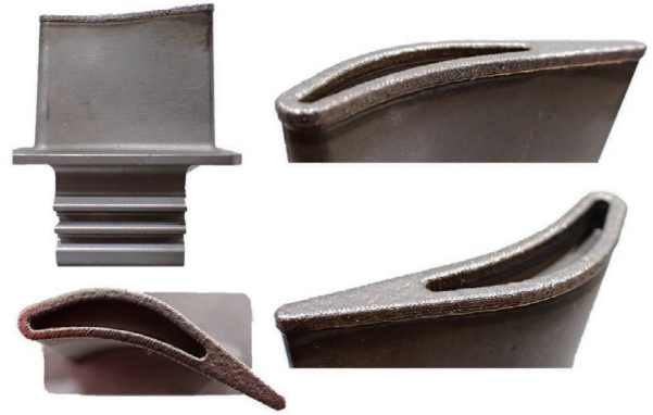
Fig. 10 タービンプレード翼頂 (チップ) 補修
