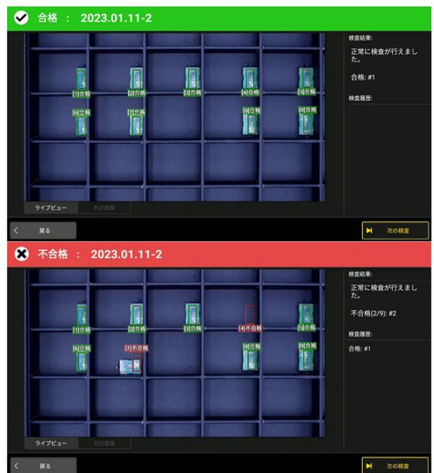
Fig. 9 部品欠品検査
