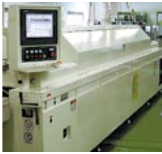
鉛フリーはんだ付けのための高性能リフロー炉
