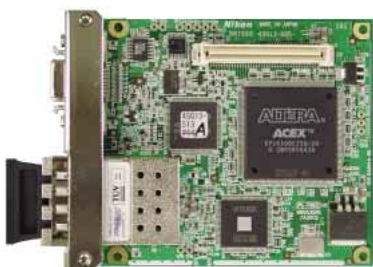
最新の液浸タイプの半導体露光装置の鉛フリー実装基板
