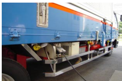
外部電源供給の様子
