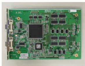
鉛フリー実装の事例：最新の半導体露光装置に用いる通信基板
