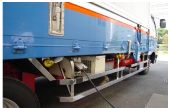
外部電源供給の様子
