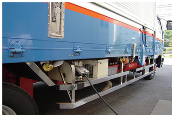
外部電源供給の様子
