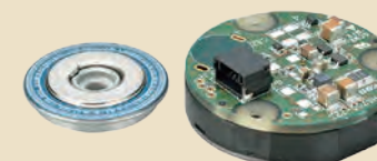
多回転アブソリュートエンコーダ「MAR-M50A」の本体外観(右)と内部のディスク(左)
