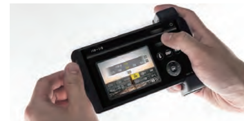
GUI操作のシミュレーターを作成し、操作性を検証
